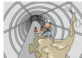
下水道工事で、豪雨により現場工区内に土砂が流入し、鉄筋型枠内に土砂が堆積した。
